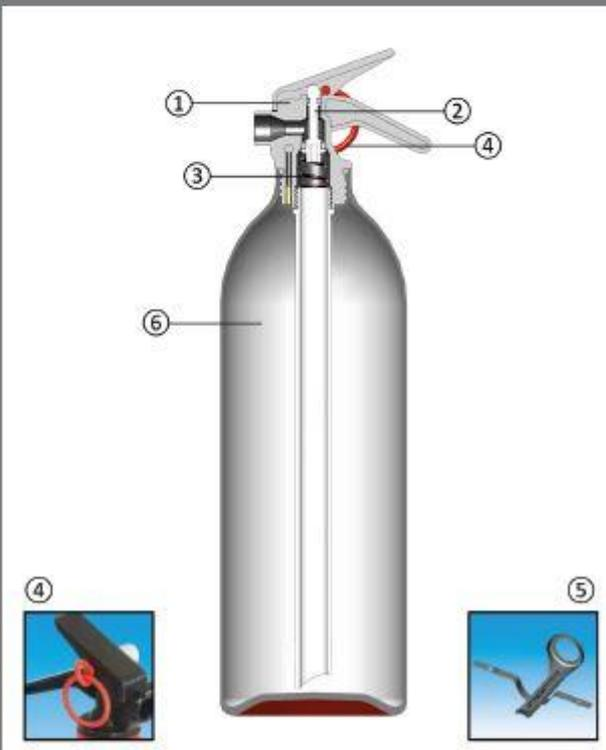
① La vanne est constituée de résine acétal en assurant une protection parfaite contre la corrosion.
