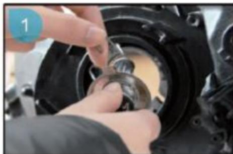
Débrancher et retirer la lampe d'origine
