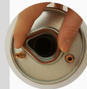
6- Humidifier le joint caoutchouc avec du carburant et le mettre sur la cuve. Monter la cuve avec le couvercle.
